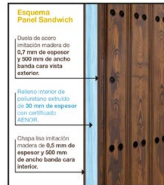
El panel de acero sandwich imitación madera se utiliza para cerramientos, fachadas y para la fabricación de puertas basculantes, correderas y residenciales.
