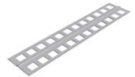
El perfil de protección y seguridad es una lámina de 30 mm de ancho y 0,8 mm de espesor, con perforaciones cuadradas de 8x8 mm y un nervio central rigidizador. Dicho perfil se incorpora mediante soldadura bajo los separadores.
