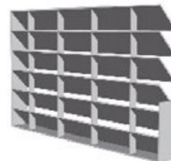
Pueden ejecutarse con una variada gama de pletinas (lamas desde 25x2 hasta 60x3), y la distancia entre lamas puede oscilar entre 20 y 90 mm.
