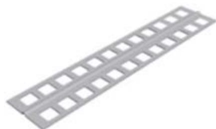
El perfil de protección y seguridad es una lámina de 30 mm de ancho y 0,8 mm de espesor, con perforaciones cuadradas de 8x8 mm y un nervio central rigidizador. Dicho perfil se incorpora mediante soldadura bajo los separadores.
